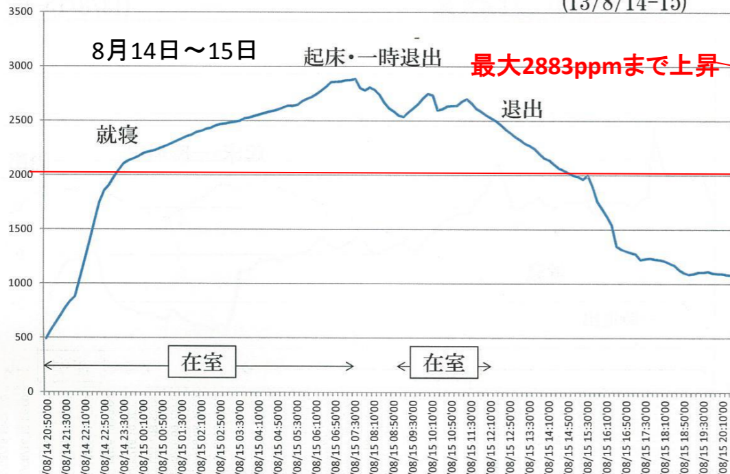
【W邸 夏CO2実測結果②】 グッドマン・窓・ドア“全閉” 最大2883ppm (13/8/14-15)
